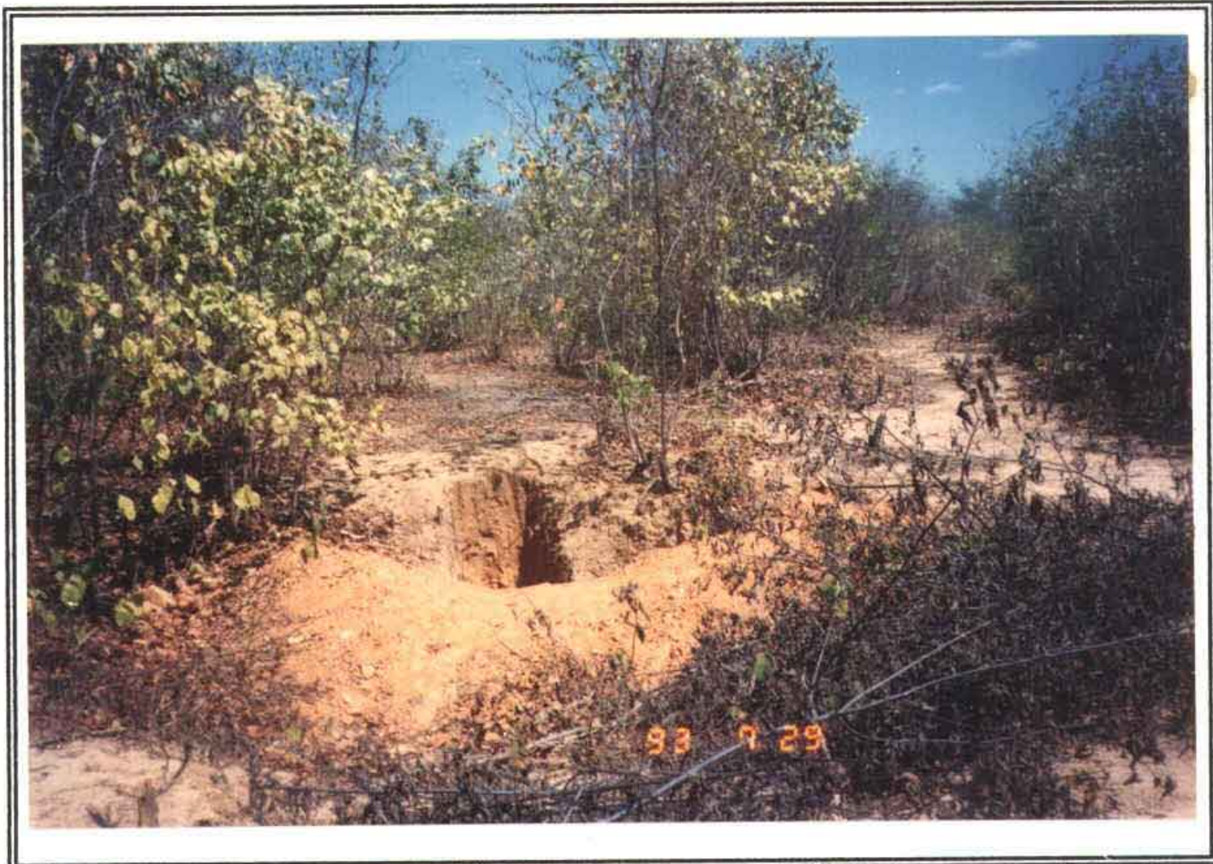
Foto 13 - Vista de uma área escolhida para jazida terrosa, vendo-se um furo de sondagem.
